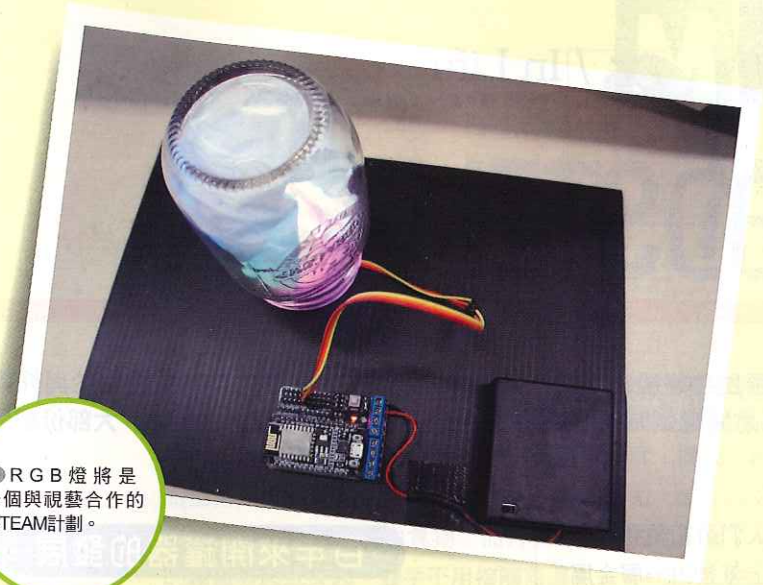
●通過Blynk App，可控制RGB顏色構成的元素和變化。
