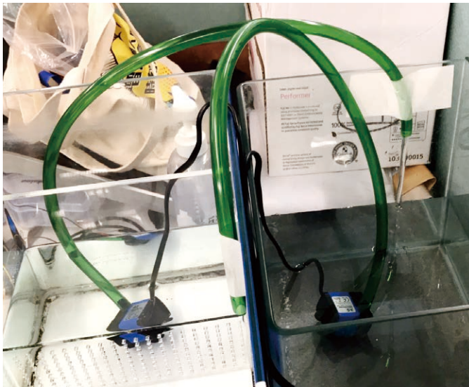
■ 利用水底水泵抽水。
