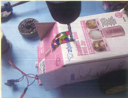
Step 1 在盒的頂部後方，用3mm鑽咀鑽一個小孔。
