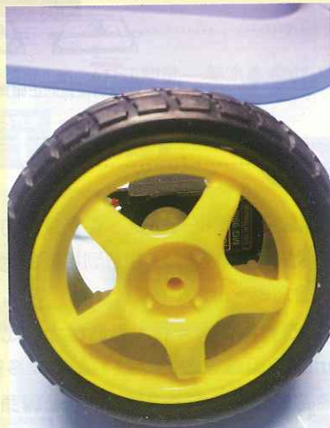
Step 3 接著用3mm鑽咀鑽穿車輪，用3mm螺絲可穿過車輪並裝上伺服馬達。
