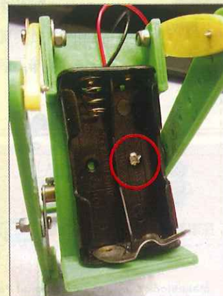
Step 2. 用5mm尖頭短螺絲把電箱固定在機械人背上。
