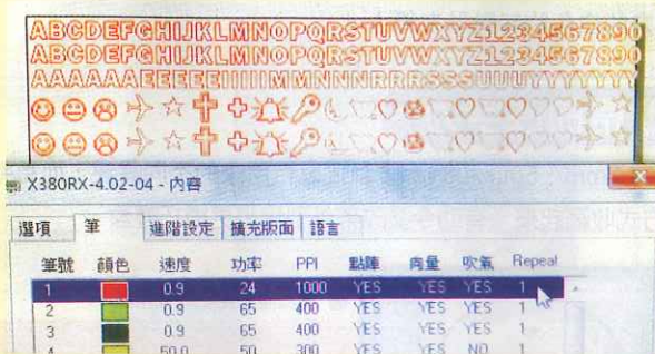
Step 5 輸入英文字母A~Z和數字0至9，數據參考：設定字母（對應顏色：紅色）的火力（24W）和速度（0.9）。
